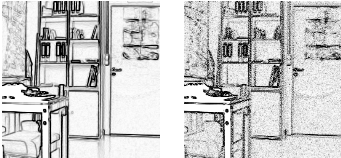
Abbildung 11.6: Ergebnis des Prewitt-Operators (links) und des Laplace-Operators (rechts), angewandt auf dieselbe Bildvorlage. Das Kantensbild wurde mit Hilfe eines Schwellwertverfahrens aus dem Betrags-Ergebnisbild erzeugt. Deutlich ist die wesentlich höhere Rauschempfindlichkeit des Laplace-Operators zu erkennen.
