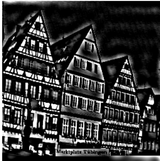
Abbildung 10.17: Bei der Hochpaßfilterung bleiben nur Stellen mit starken Grauwertänderungen (hochfrequente Anteile) unbeeinflusst. Zur Vereinfachung wurde hier nicht ein runder, sondern ein quadratischer Filterkern verwendet.
