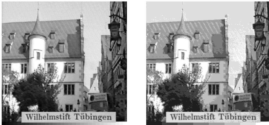
Abbildung 10.3: Eine Quantisierung auf 32 Stufen ist im normalen Bild (links) oft noch nicht zu erkennen. Nur im Graukeil sind die Abstufungen zu erahnen. Bei nur 8 Graustufen (rechts) ergeben sich jedoch fiktive Konturen.
